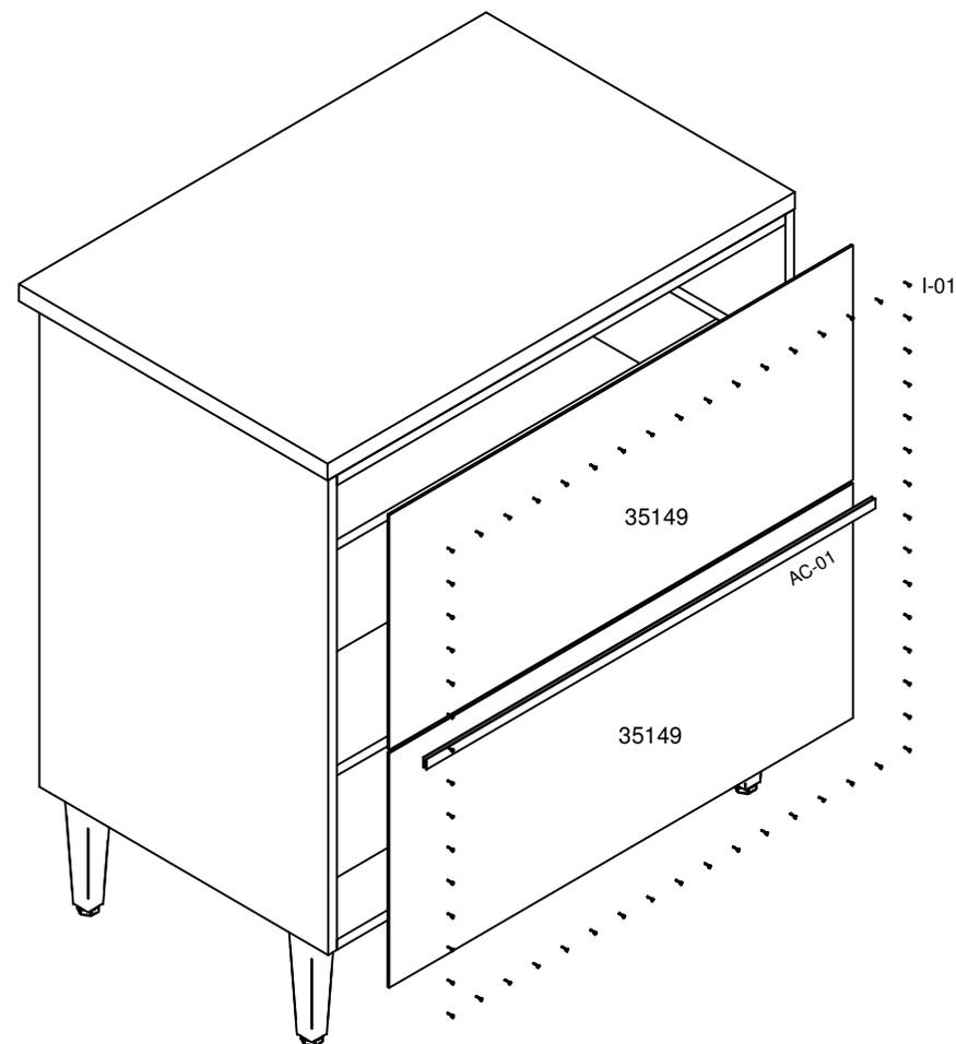
**Passo 2:** Fixar os trilhos telescópicos com parafusos **B-08**. Usar parafusos e cavilhas para montagem do gavetão. Usar parafusos **B-18** para fixar os puxadores. Para melhor acabamento, usar ponteiras nos puxadores.
