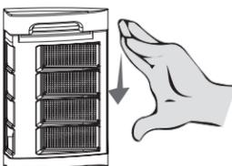
• Aperte a trava do filtro, puxe para frente e desloque para cima conforme o desenho ao lado. Com o filtro fora da máquina, lave em água corrente, lembrando que o filtro deverá ser limpo ao término de cada lavagem de roupa. (Para recolocar o filtro, basta fazer o processo inverso.)
