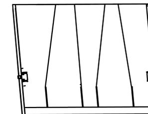
Em seguida retire as travas de arame, fazendo um movimento .....horizontal para fora. Retire a manta saturada, e em seguida coloque a nova e repita o procedimento anterior para o fechamento da grade.
