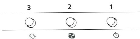
O painel do Depurador Bivolt é composto de 3 botões conforme a figura acima.
