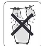
Evite instalar sua Lavadora embaixo de varais e locais expostos a chuva, goteiras ou excesso de umidade (ex. banheiro).
