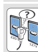
Antes de ligar a sua Lavadora, verifique se a tensão (voltagem) da tomada onde a Lavadora será ligada é igual a tensão indicada na etiqueta localizada próxima ao plugue (no cabo elétrico).
