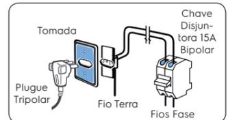
Para a Lavadora 220V (entre duas fases), utilize um disjuntor bipolar de 15A.
