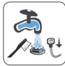
Feche a entrada de água. Desconecte a extremidade da mangueira da torneira. Limpe o filtro com um jato de água e se houver dificuldades na remoção das impurezas utilize uma pequena escova. Este procedimento deve ser feito periodicamente para evitar o entupimento do filtro. Caso o filtro esteja danificado e necessite substituição entre em contato com o Serviço Autorizado Electrolux. Não esqueça de recolocar o filtro, conectar a mangueira e abrir novamente a torneira.
