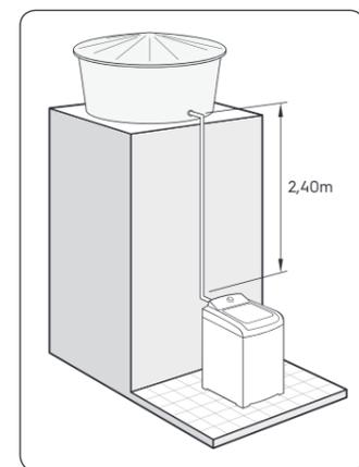
Para garantir uma pressão adequada de enchimento, deve-se ter uma altura mínima entre a base da caixa d'água e a entrada da Lavadora de 2,40m.
