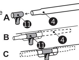
*A- Introduzca el conector en "T" **11**, en una de las puntas del tubo **4**.*
