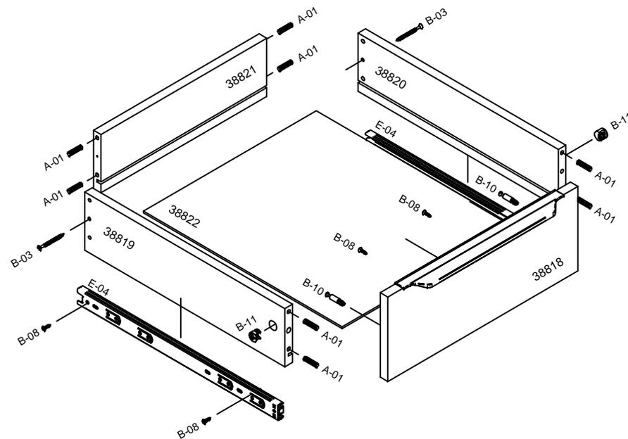
**Passo 2:** Fixar os trilhos telescópicos com parafusos **B-08**. Usar parafusos e cavilhas para montagem do gavetão. Usar parafusos **B-08** para fixar o puxador.
