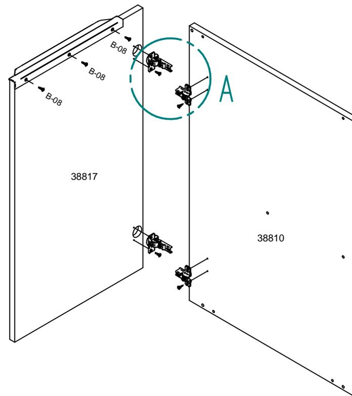
**Passo 4:** Fixar os trilhos telescópicos na divisão e lateral direita usando parafusos **B-08**.
