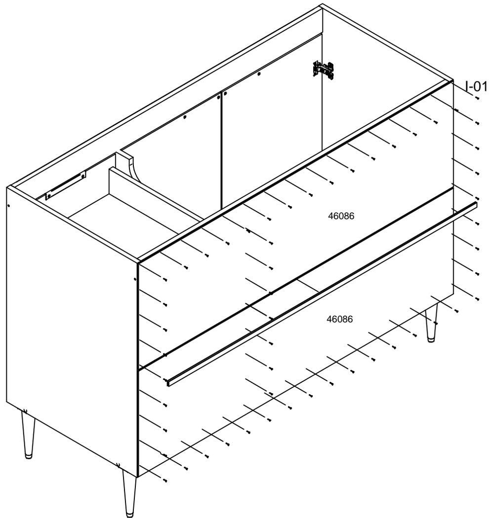
**Passo 1:** Usar cavilhas, parafusos Bigfix e tambores para montagem das laterais c/ as frentes. Usar parafusos B-03 e cavilhas para montagem das laterais c/ os traseiros. Usar parafusos B-08 para fixar o puxador. Usar parafusos B-08 para fixar as corredeiras.
