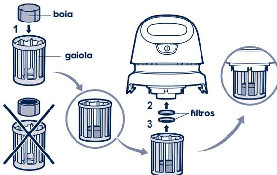
**3** **Filtros sujos ou saco descartável cheio diminuem a performance**, caso isso aconteça proceda com a troca do saco descartável ou limpeza dos filtros, da seguinte forma:
